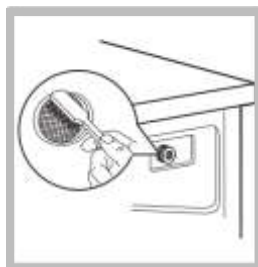
З'єднайте шланг подачі води
